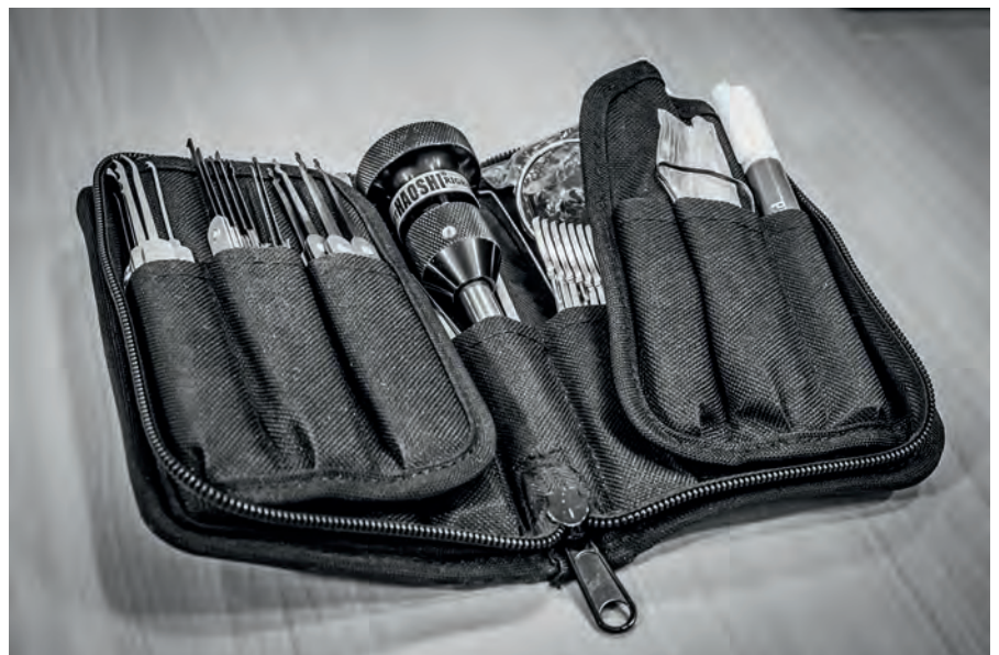
Photo 2 : trousse à outils généralistes pour serrures à goupilles, pour la pratique du crochetage et de quelques autres techniques assimilées.
