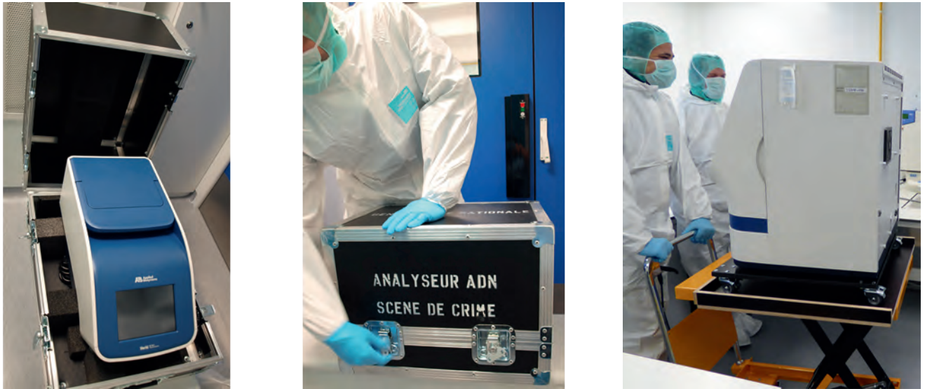
Figure 5 : Illustration du déplacement des instruments analytiques dans le laboratoire mobile.
