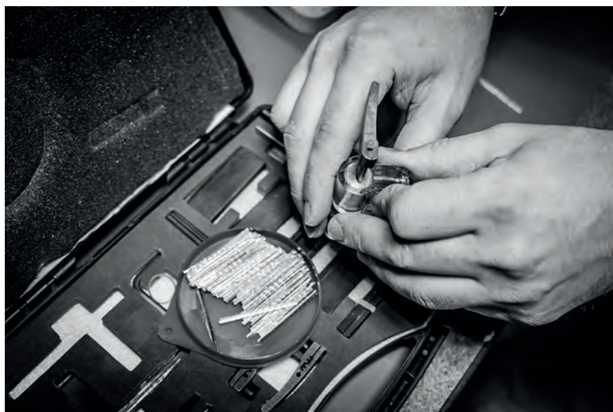
Photo 5 : outils destinés à ouvrir principalement des serrures de type radiales (clés horizontales à micros points), par la méthode d'auto-impressionning, ou « clé molle ».
