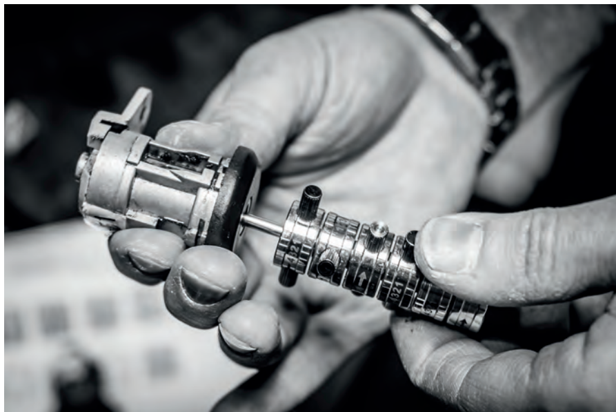
Photo 3 : outil spécialisé, dédié aux serrures TIBBE présentes sur certains véhicules Ford et Jaguar.
