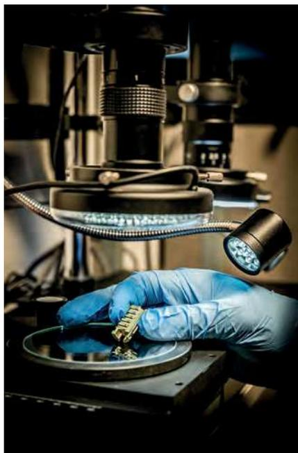
Un demi rotor de serrure prêt à être examiné à la recherche de microtraces.
